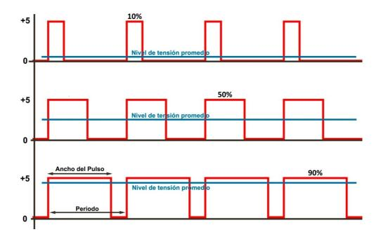
El nivel de tensión que tendremos a la salida del pin, va a ser igual al nivel de tensión promedio proporcional al ancho de los pulsos.
