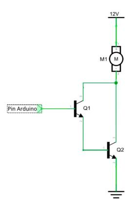
Esta configuración se consigue usando 2 transistores bipolares en tándem. Es muy común el uso de integrados que poseen en su interior transistores configurados de esta manera y que ahorran tiempo y espacio a la hora de crear circuitos complejos.
