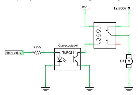
Los relés suelen usarse para controlar cargas de todo tipo, ya que es muy amplio el catalogo de relés que existe. La única limitación que tienen los relés frente a los mosfet de potencia es el ciclo de trabajo, los relés no están pensados para conmutar a mucha velocidad, ni para funcionar como reguladores con el PWM. Los relés se utilizan para activar o desactivar cargas de todo tipo siempre que los ciclos de conmutación no sean demasiado elevados.
