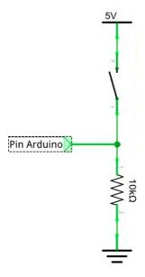
El colocar una resistencia de PullUp o PullDown va a hacer que el pin de Arduino esté conectado siempre a un estado lógico ALTO o BAJO y que al cerrar el pulsador o interruptor no se conecten la alimentación y GND directamente, (lo que ocasionaría un cortocircuito) ya que hay una resistencia de 10K $\Omega$  entre ambos.
